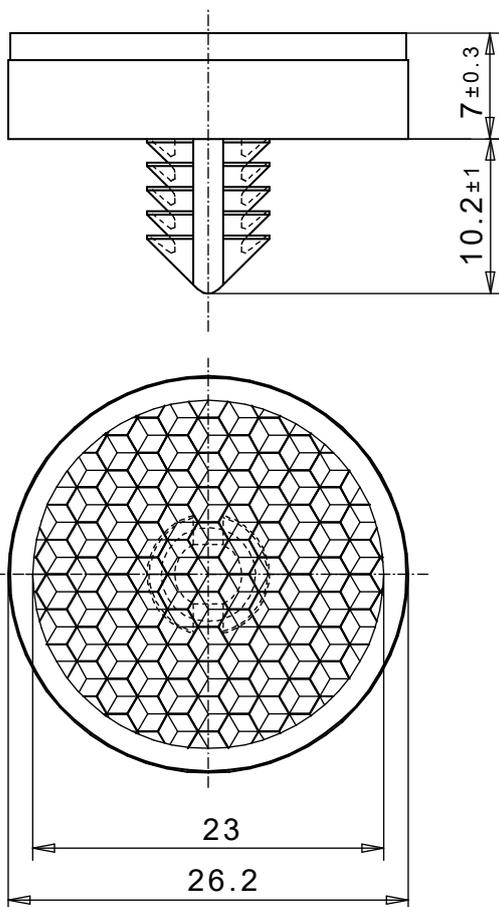
Clip passend für Bohrung 6-7mm
