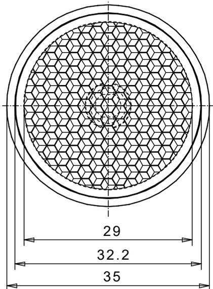
Clip passend für Bohrung 7mm
